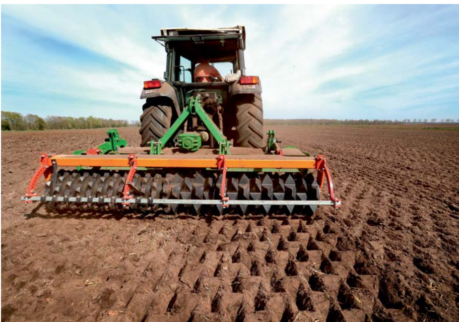
Het perceel ziet er uit als een wafel. Dankzij de ondiepe infiltratieputjes blijft het water op het perceel en spoelt niet af naar een sloot.
