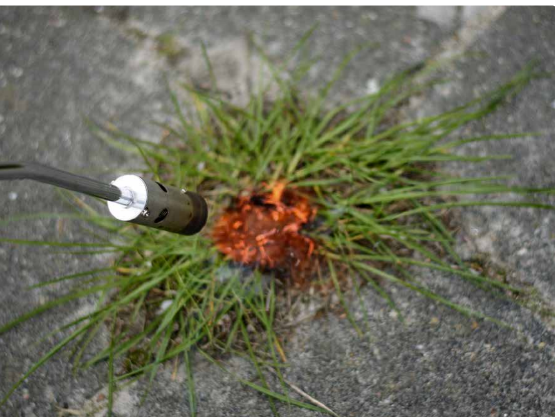
MET EEN ONKRUIDBRANDER IS ONKRUID ZONDER GEBRUIK VAN CHEMISCHE MIDDELEN IN DE HAND TE HOUDEN
